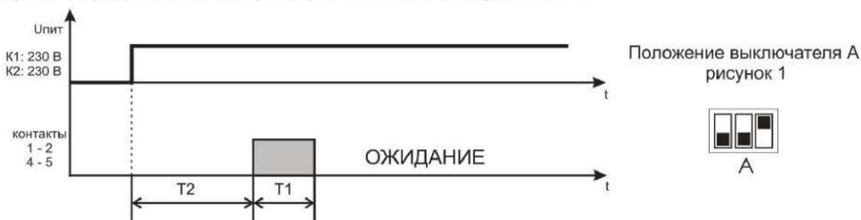
Рисунок 4 – Алгоритм работы Реле импульсное 1
