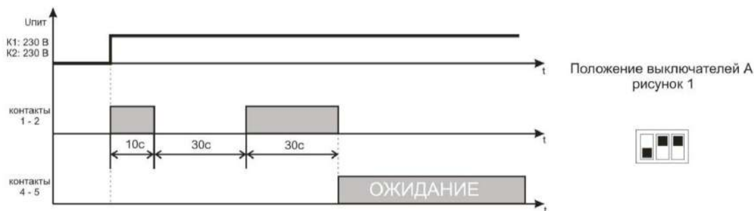
Рисунок 6 – Алгоритм работы Реле управления (предпусковая сигнализация)
