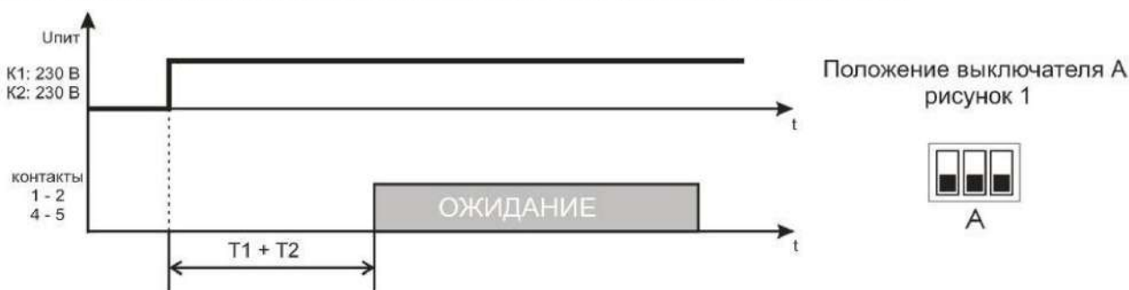
Рисунок 3 – Алгоритм работы Реле с задержкой на включение
