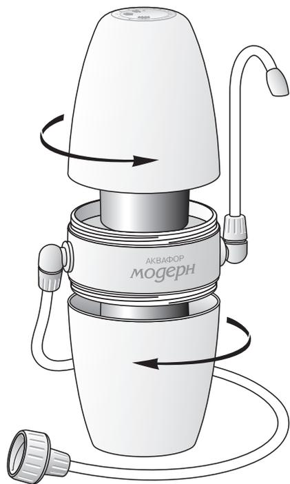
Не забывайте вовремя менять модули в вашем фильтре. Для замены модулей отверните верхний и нижний полукорпуса фильтра, выньте модули и аккуратно установите новые. Не забудьте установить на календаре следующую дату замены модулей, после чего плотно заверните полукорпуса. После установки новых модулей промойте фильтр. Для этого пропустите через него воду в течение 10–15 минут при производительности 1,0–1,2 л/мин. Фильтр снова готов к работе.
