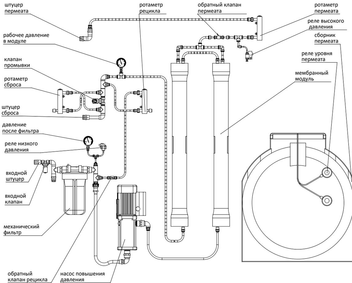
Рисунок 2. Схема системы обратного осмоса Ecosoft MO-12000
