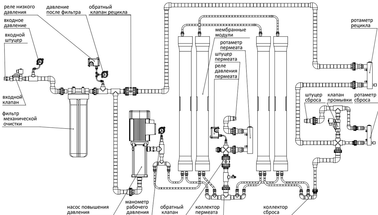
Рисунок 3. Схема системы обратного осмоса Ecosoft MO-24000
