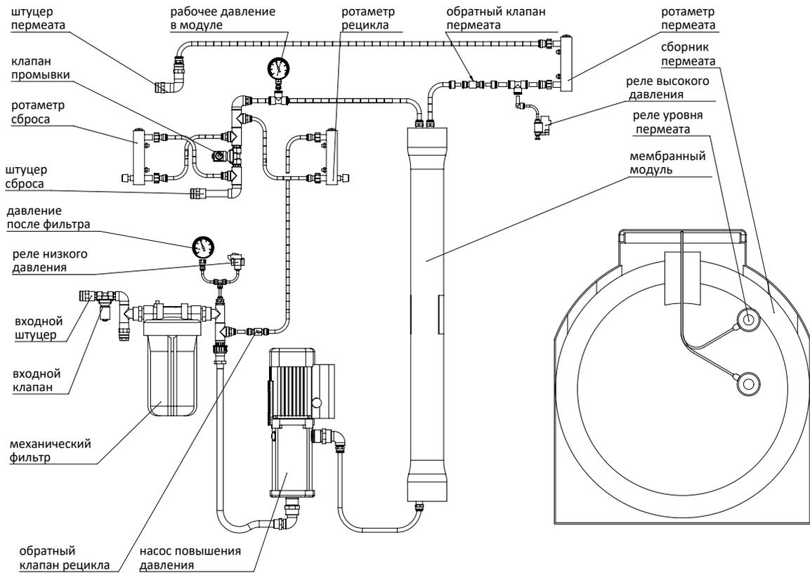
Рисунок 1. Схема системы обратного осмоса Ecosoft MO-6500
