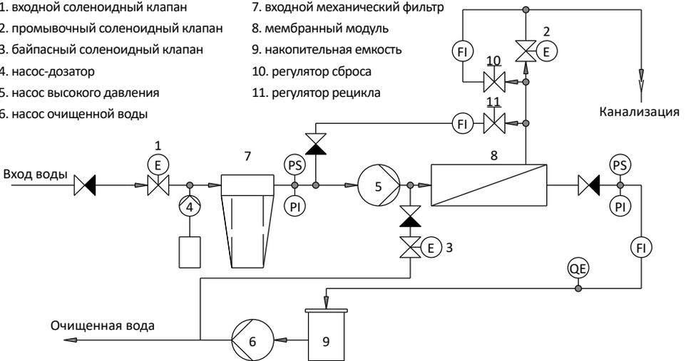
Рисунок 2. Система обратного осмоса с промывкой очищенной водой
