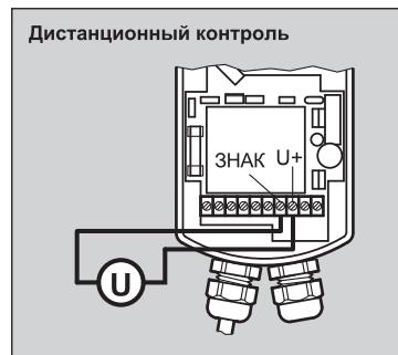
Для дистанционного контроля открытого или закрытого положения шарового клапана рекомендуется использовать центральную систему сигнализации с входным напряжением от 0 до 10 В. Максимальный допустимый ток равен 10 мА. Величина сигнала на уровне от 5 до 10 В указывает на присутствие сетевого тока и на то, что выпускной клапан закрыт.
