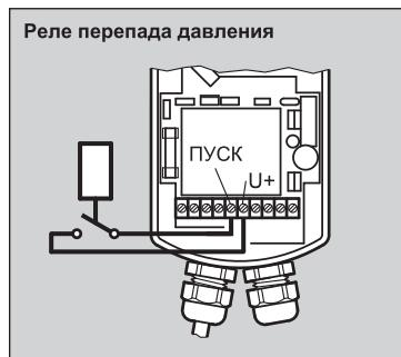
Функцией обратной промывки можно по мере необходимости управлять при помощи реле перепада давления DDS 76 с микропереключателем, имеющим "сухие" контакты. Рекомендуется устанавливать перепад давления на уровне 1,0 бар.
