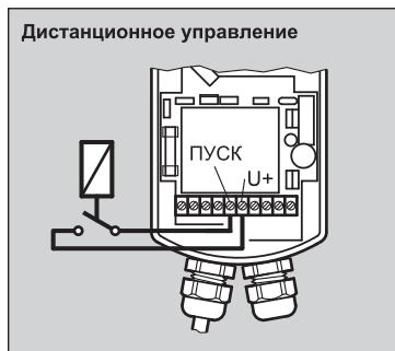
Приводом Z 11 S можно управлять дистанционно при помощи реле с перекидными "сухими" контактами (например, реле Honeywell Centra типа REL 2). Минимальное время удержания контактов реле для активизации обратной промывки составляет одну секунду.
