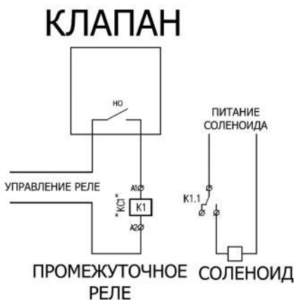
Рис.4 Схема подключения при подаче воды на COO
