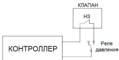
Рис.2 Схема подключения клапана в разрыв сухого хода
