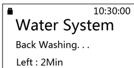
Если вы хотите закончить этот режим, снова нажмите клавишу ESC. И клапан немедленно перейдет в следующее рабочее состояние (если нет, клапан сам может завершить процесс регенерации). Остальные рабочие состояния регенеративного прогресса ниже:
