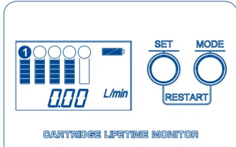
Для просмотра показаний по другим ступеням нужно выбрать фильтроэлемент последовательными нажатиями кнопки SET (номер выбранной ступени будет отображаться в черном круге).
