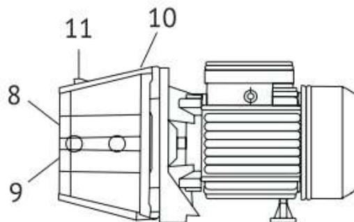
На корпусе насоса находятся два отверстия входной магистрали (8)-11/4" и (9)-1", выходное отверстие- (10)-1" и отверстие для первоначальной заливки воды- (11).
