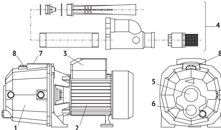
Насос состоит из следующих основных узлов: гидравлической части (1), электродвигателя (2), пускового устройства (3) и внешнего эжектора (4). В конструкцию внешнего эжектора входят следующие детали: корпус, трубка Вентури, сопло, патрубок, уплотнительные кольца, обратный клапан с сеткой. Корпус насоса имеет два отверстия входной магистрали 1¼" (5) и 1" (6), выходное отверстие 1" (7) и отверстие для первоначальной заливки воды (8).
