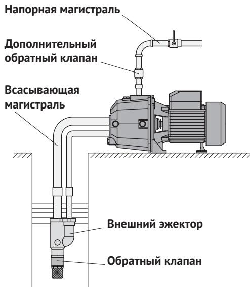
Всасывающая магистраль выполняется из двух несжимаемых шлангов или труб, внутренний диаметр которых должен быть не меньше, чем диаметр соответствующих отверстий (5) и (6) в корпусе насоса – 1¼" и 1" соответственно. На конце входной магистрали всасывающая и питающая трубы соединяются с внешним эжектором, на входе которого устанавливается обратный клапан 1" с сеткой.
