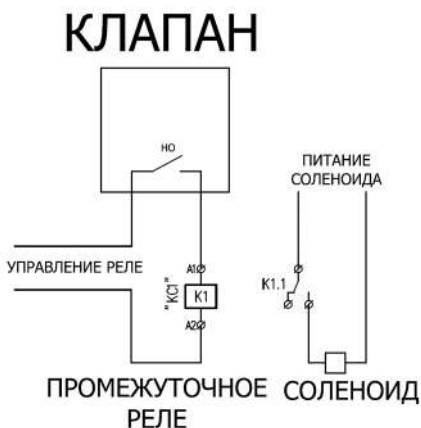
Рис.4 Схема подключения при подаче воды на СОО
