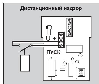
Приводом Z 74 A можно управлять дистанционно при помощи реле с перекидными "сухими" контактами (например, реле Honeywell Centra Bürkle типа REL 2). Минимальное время удержания контактов реле для активизации обратной промывки составляет одну секунду.
