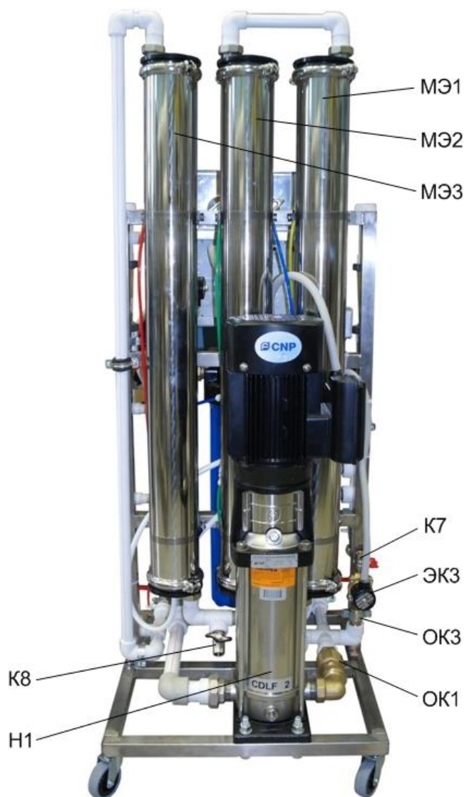
Рис.2 Общий вид установки (со стороны насоса).
