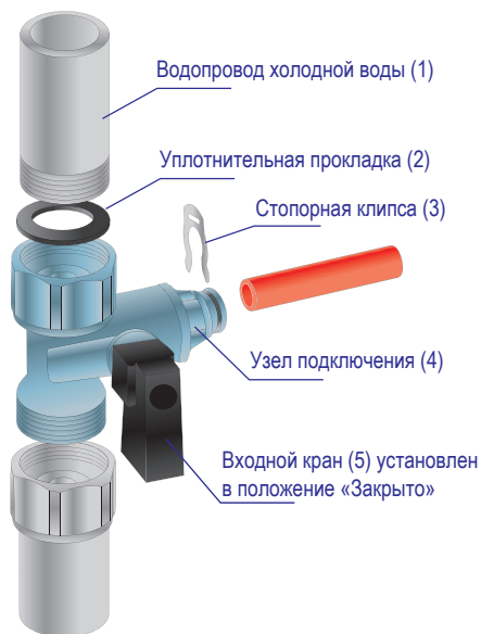
Рис. 3. Схема установки узла подключения
