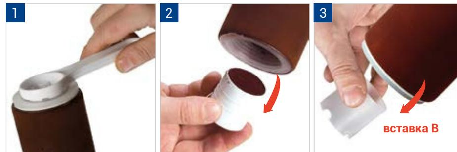
**Очистка от солей железа (проводится после механической очистки)**
