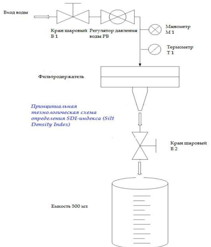
11. Закройте входной вентиль В-1 и сбросьте давление с измерительного модуля, открыв для этого вентиль В-2. После чего вентиль В-2 закройте.
