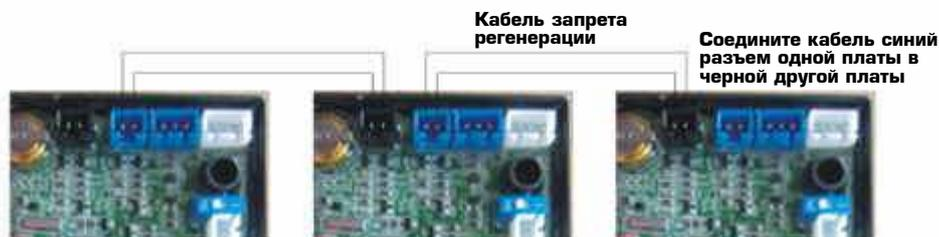
Примечание: Если в одной системе с несколькими клапанами блокирующий кабель отключен, то система будет разделена на две отдельные системы.
