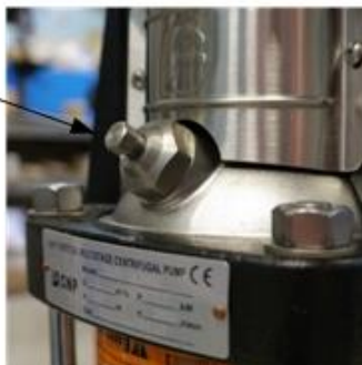
Рис.7 Пробка на насосе для выпуска воздуха.
